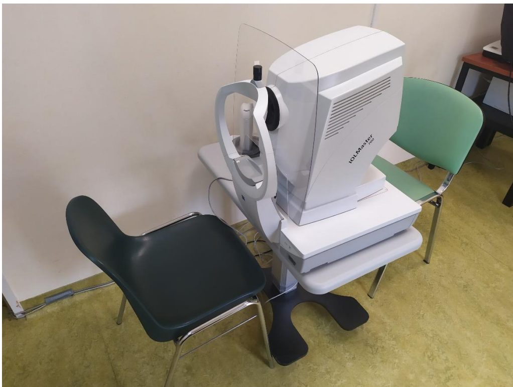
Aparatu do naliczania wszczepów wewnątrzgałkowych
